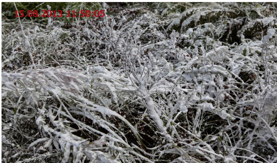
Рисунок 1. Внешний вид компрессионной пены (сухой) на поверхности растительности через 4 минуты после подачи ее на растительный покров
