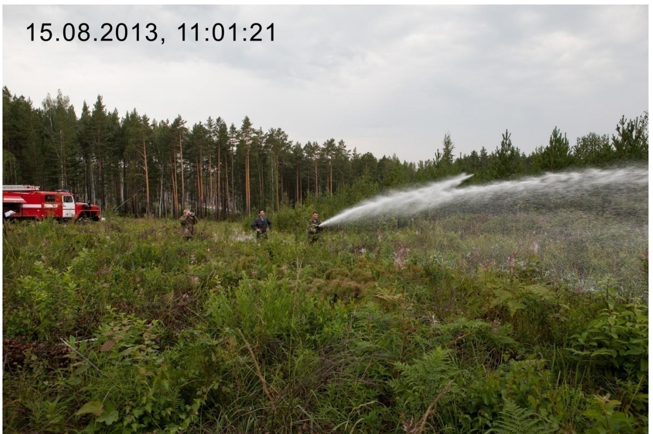
Рис. 4.2. Использование системы пожаротушения NATISK для получения полосы компрессионной пены (сырой) на поверхности растительности
