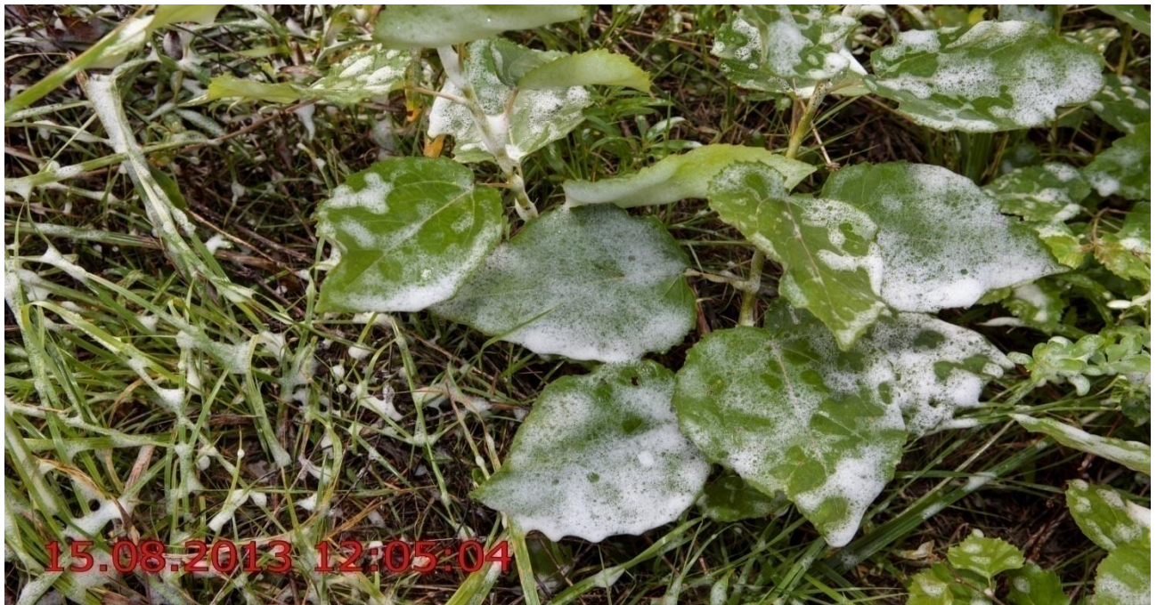
Рис. 4.12. Внешний вид листьев березы через 8 минут после подачи компрессионной пеной (сухой), полученной с помощью системы пожаротушения NATISK
