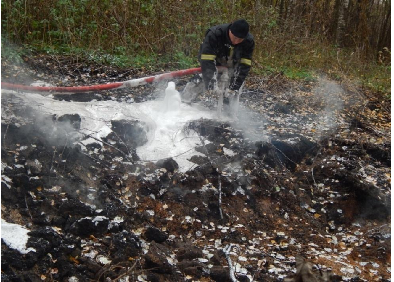
Рис. 4.23. Тушение торфяного пожара компрессионной пеной с использованием модернизированного торфяного ствола
